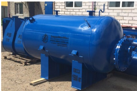
Емкостной подогреватель воды ВПЕГ-2,5; труба дымовая в каркасе; оборудование для очистки дымовых газов от котлов паровых серии Е для комбикормового завода в Львовской области
