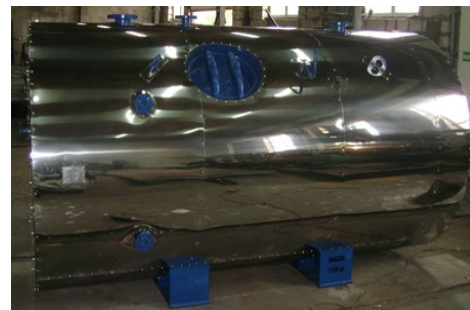
Аккумулятор пара горизонтальный АПГ-4000 для завода по выращиванию грибов (г. Умань, Черкасская обл.)
