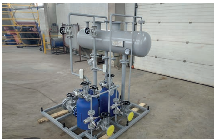
Конденсатна насосна станція на базі поплавкових насосів Ari (Німеччина) в комплекті з ресивером (агропромислове підприємство, Тернопільська обл.)
